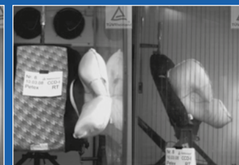
Zu erkennen ist, dass die Sollreißnaht des Sitzbezuges sich öffnet...
