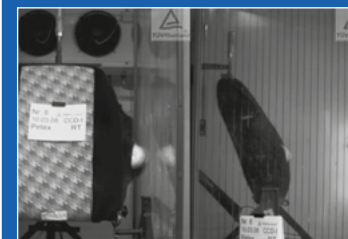
Bilder einer High-Speed-Kamera bei einem sog. „Airbag-Entfaltungsversuch“
